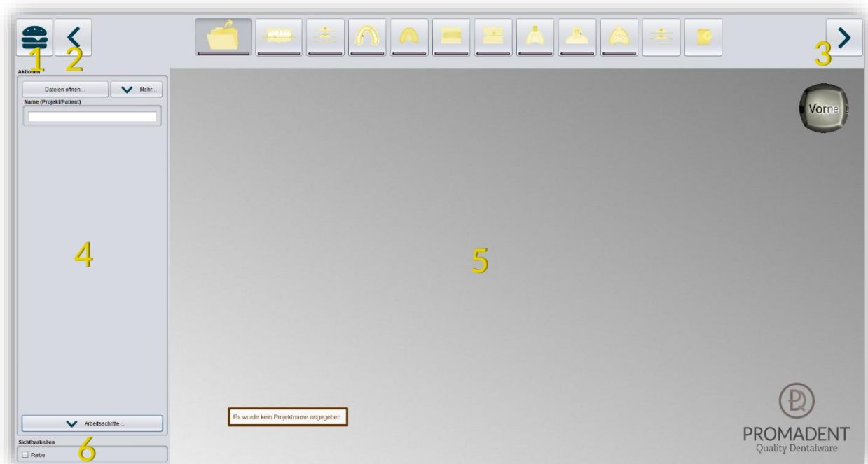
Bild 2: Das Programm BiSS nach dem Start. 1) Menü: Enthält Einstellungen, über uns, andere Anwendung wählen, neues Projekt. 2) Zurück: gehen Sie zu dem vorherigen Schritt zurück. 3) Nächster Schritt: Derzeitigen Bearbeitungsschritt abschließen und zum nächsten Schritt übergehen. 4) Aktionsfenster: Individuell für den jeweiligen Arbeitsschritt. Hier: Datei laden und Festlegen der Arbeitsschritte. 5) Arbeitsfläche. 6) Sichtbarkeitsschalter. Sichtbar nach Laden der Scans.
