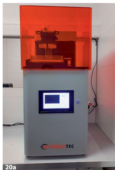
Abb. 18 und 19 Der im BISS Dental Modell-Creator erstellte Datensatz ist hier in die CAM-Software des Druckers importiert; Modelle mit herausnehmbarem Zahn und Gingivamaske. Abb. 20a und b Das Drucken des Modells im 3-D-Drucker (Fa. EnvisionTec, Gladbeck).
